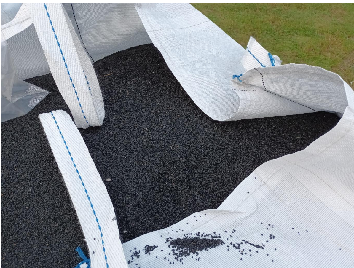
Kuva 6-1. SBR-kumirouhe odottaa suursäkissä tekonurmikentälle levittämistä.
