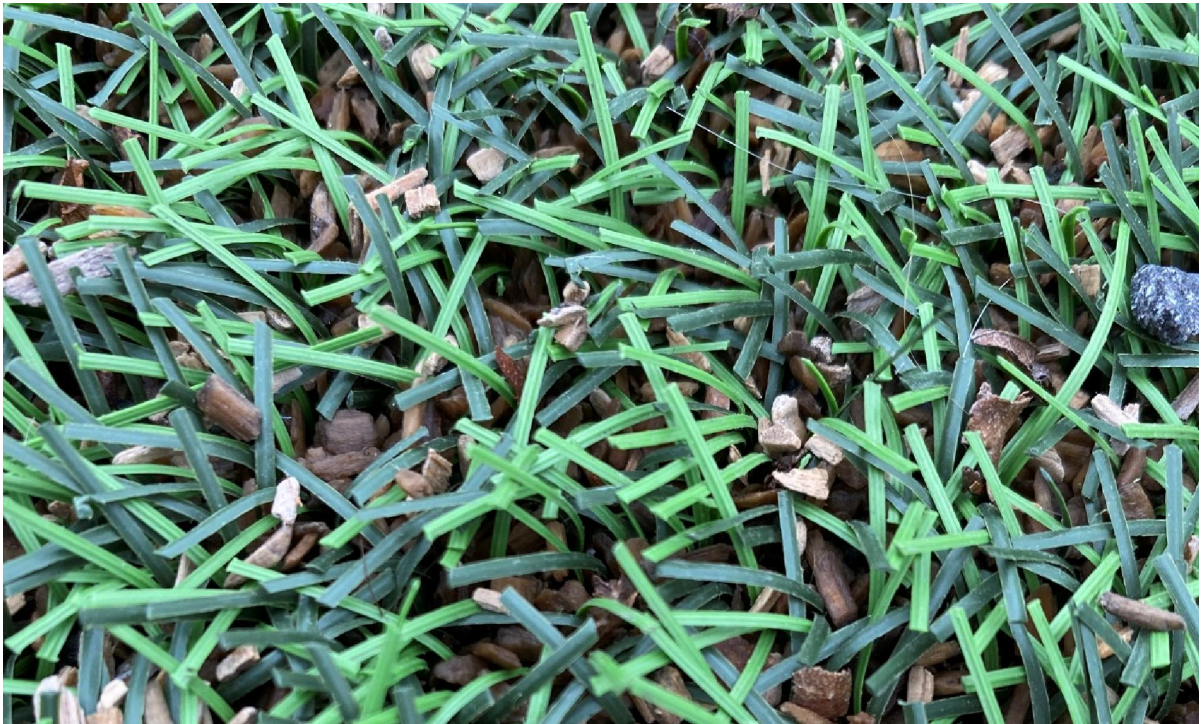
Kuva 6-2. Mäntypuurouhetta tekonurmen täyteaineena.
