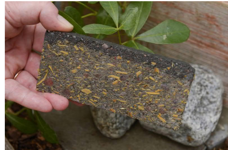
Esimerkki tuotteesta, jossa eri materiaalit yhdistyvät uudeksi tuotteeksi: Destaclean Oy:n puun, kiven ja betonin komposiitista valmistettu rakennusaineena käytetty puukivi, jonka tilavuudesta jopa 50 prosenttia on kierrätyspuumursketta. Kuva: Destaclean Oy
